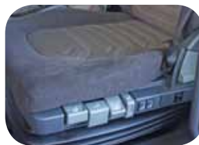
כסא נהג פנאומטי ברמת גימור גבוהה, בעל דרגות כיוון שונות וחימום חשמלי
