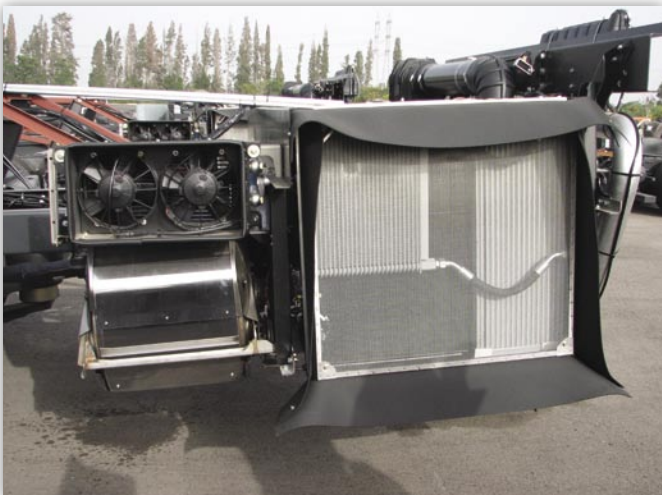
מערכת קירור מוגנת על ידי רשת כנגד ליכלוך חיצוני
