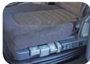
כסא נהג פנאומטי ברמת גימור גבוהה, בעל דרגות כיוון שונות וחימום חשמלי
