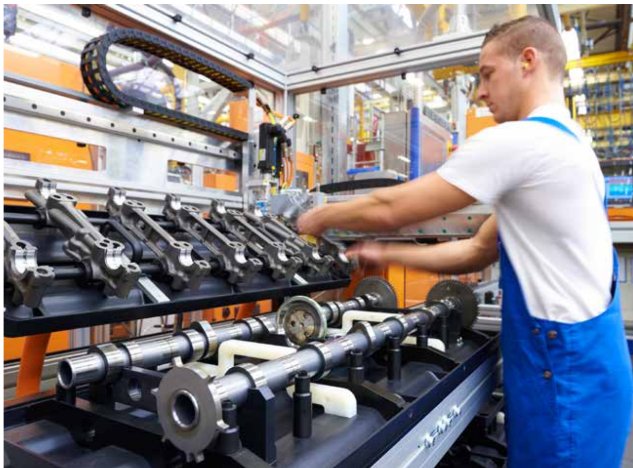
גלי הזיזים של המנוע החדש. מפעל המנועים באיינדהובן
